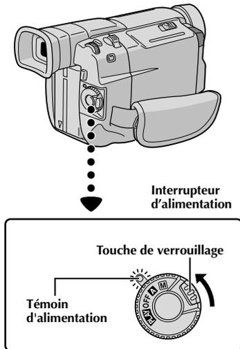
Lorsque l'interrupteur d'alimentation est réglé sur "A", "F. AUTO" apparaît. Réglé sur "M" ou "PLAY", il n'y a pas d'indication.
