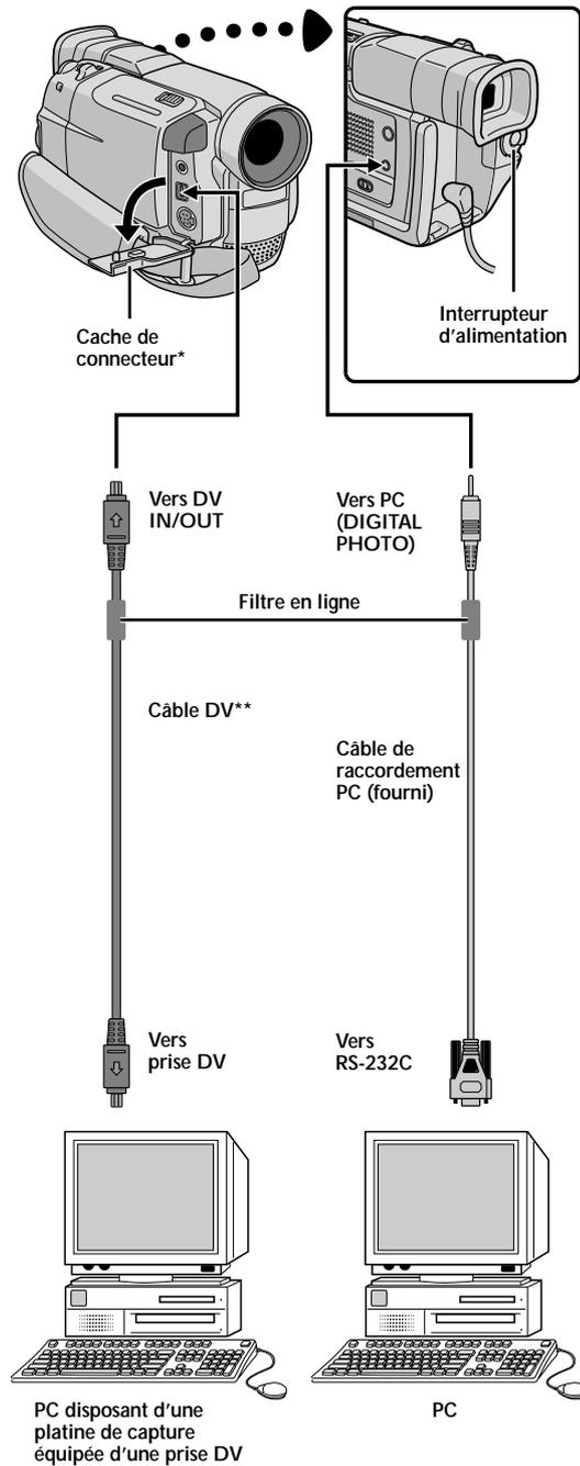
\* Pour raccorder le câble, ouvrir ce cache.
