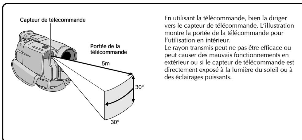
En utilisant la télécommande, bien la diriger vers le capteur de télécommande. L'illustration montre la portée de la télécommande pour l'utilisation en intérieur.
