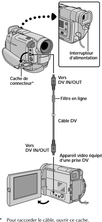
\* Pour raccorder le câble, ouvrir ce cache.
