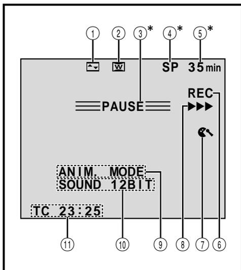
\* Régler "ON SCREEN" sur "SIMPLE" dans l'écran de menu vous permet de retirer les indications marquées d'une astérisque (\*) de l'écran (☞ p. 33, 46).
