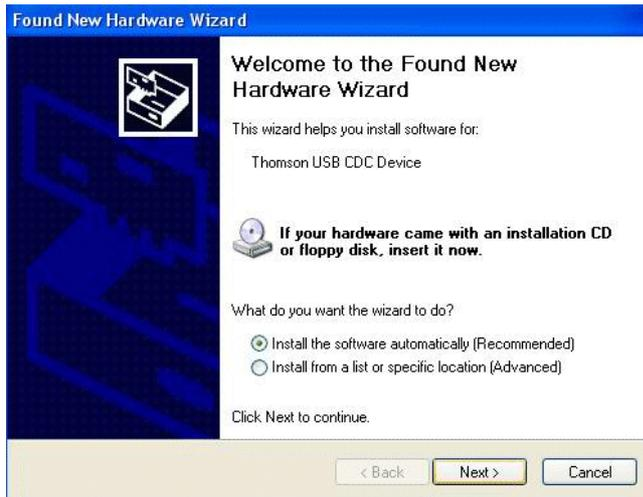
*Attention : Si Windows XP ne détecte pas la présence du modem câble, à savoir si « Welcome to the New Hardware Wizard » ne s'affiche pas automatiquement, les paramètres du BIOS n'acceptent certainement pas les périphériques USB et/ou Plug-and-Play. Contactez le service après-vente du constructeur de votre ordinateur.*
