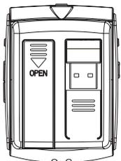
2. Insérez une pile de type "AAA"(UM4) en veillant à respecter les polarités indiquées dans le compartiment.
