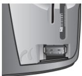
2. Verwijder de kap van de HP bt500 en sluit de adapter aan op de poort.
