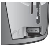
2. 取下 HP bt500 的端盖，将其插入端口。
