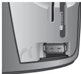
2. HP bt500 のキャップを取り外し、ポートに挿入します。
