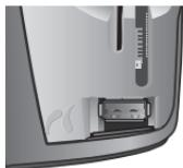
2. Odstranite pokrov z vmesnika HP bt500 in slednjega vstavite v vrata.
