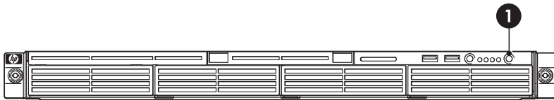
Figure 14 Mise sous tension du HP D2D Backup System
