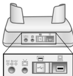
Un volet coulissant protège les ports de connexion à l'ordinateur et à l'imprimante, afin d'éviter d'utiliser les deux connecteurs à la fois (la station d'accueil n'est pas un hub USB).
