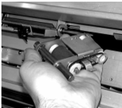
*Figure 4-51 Installation du rouleau supérieur*
