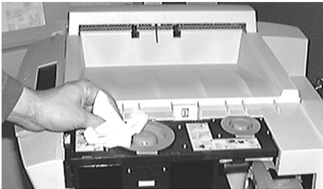
*Figure 5-1 Nettoyage de la zone du chargeur de la cartouche d'encre*
