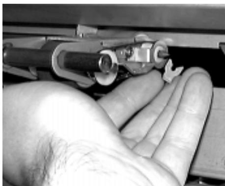
*Figure 4-52 Fixation du clip du rouleau supérieur*
