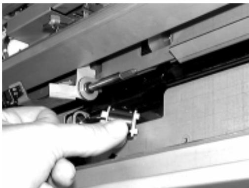
Figure 4-46 Installation du limiteur de couple
