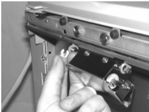
*Figure 4-69 Fixation du clip sur le rouleau inférieur*
