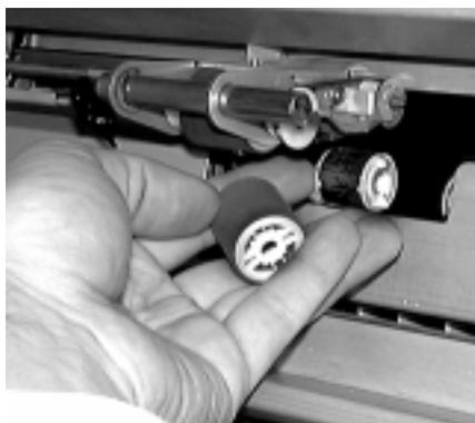
*Figure 4-42 Retrait des rouleaux inférieurs de l'axe*
