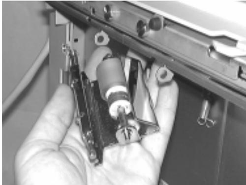
*Figure 4-68 Installation du rouleau inférieur*
