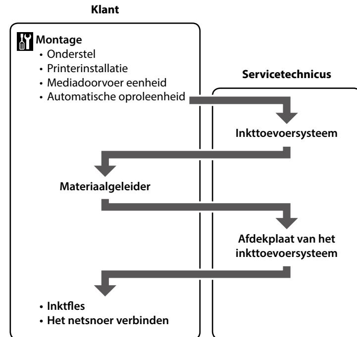
Rivolgersi ad un tecnico dell'assistenza per montare il "Sistema di erogazione inchiostro" e il "Coperchio per Sistema di erogazione inchiostro". Se si tenta di eseguire queste operazioni da soli, si potrebbero causare anomalie o danni al prodotto, con conseguente annullamento della garanzia.
