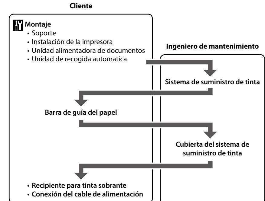
Contacte um engenheiro de serviço para colocar o "Sistema de fornecimento da tinta" e a "Estrutura de encaixe do sistema de fornecimento da tinta". Tentar a execução destas tarefas por conta própria pode causar mau funcionamento ou danos na máquina, anulando a sua garantia.
