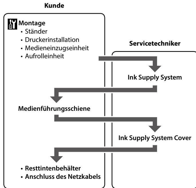
Neem contact op met een servicetechnicus om het inkttoevoersysteem en de afdekplaat van het inkttoevoersysteem te bevestigen. Als u deze taken zelf probeert uit te voeren, kan dit leiden tot een slechte werking van of schade aan het product en vervalt de garantie van het product.
