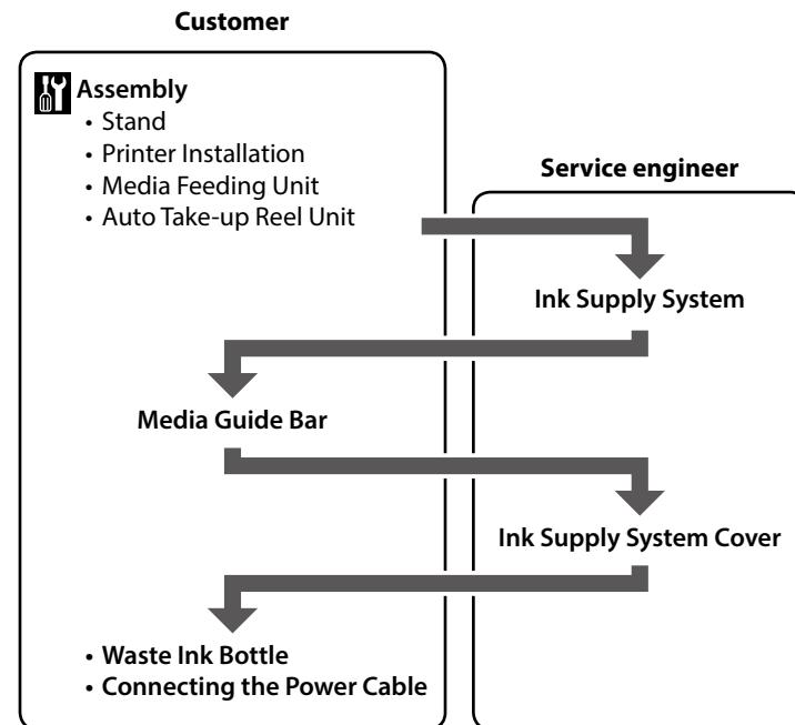
Contactez un technicien pour fixer le "système d'alimentation encre" et le "couvercle du système d'alimentation encre". Essayer de réaliser ces tâches vous-même peut provoquer le dysfonctionnement du produit ou des dommages et invalidera la garantie.
