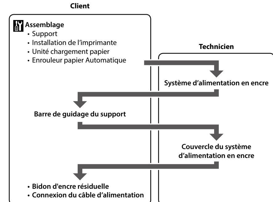
Um „Ink Supply System“ und „Ink Supply System Cover“ anzubringen, wenden Sie sich an einen Servicetechniker. Sollten Sie versuchen, diese Arbeiten selbst durchzuführen, kann dies zu Fehlfunktionen des Geräts oder Defekten am Produkt führen und der Garantieanspruch verfällt.
