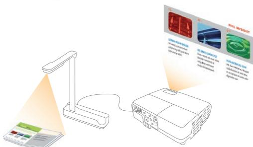
**Connexion au Visualiseur Epson** : il suffit de connecter le projecteur au nouveau Visualiseur Epson via un câble USB pour projeter directement les documents et les objets\*.
