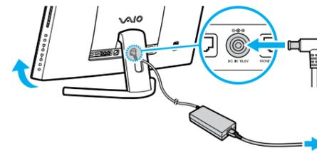
Réglez l'angle de l'écran pour pouvoir repérer le port d'entrée en c.c. derrière le socle de pied. Enfillez le câble de l'adaptateur c.a. dans l'orifice du socle de pied et branchez-le dans le port d'entrée en c.c. Branchez le cordon d'alimentation dans l'adaptateur c.a., puis dans la prise c.a.
