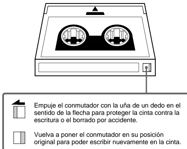
Figura 4-1. Conmutador de protección contra escritura.
