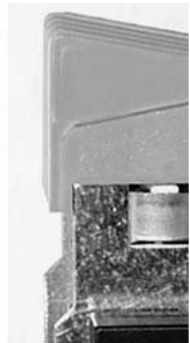
Ontvangstmodule correct gemonteerd
