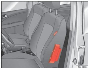
Fig. 23 Airbag latéral dans le siège du conducteur
