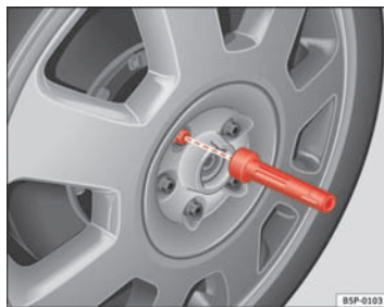
Fig. 198 Changement de roue : outil à six pans intérieur pour serrer/desserrer les vis
