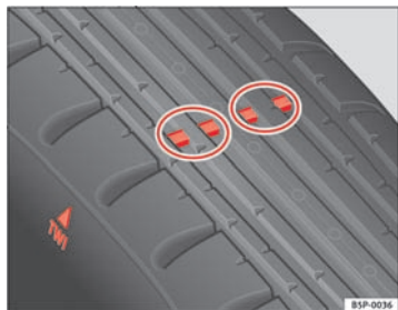
Fig. 189 Sculptures du pneu : indicateurs d'usure
