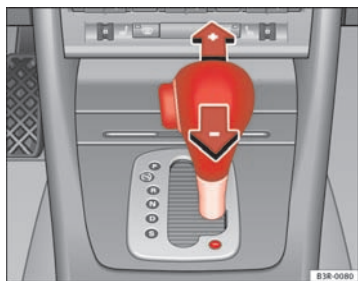
Fig. 157 Console centrale : passage manuel des rapports (mode tiptronic)
