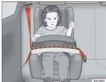
Fig. 30 Siège pour enfant du groupe 1 monté dans le sens de la marche sur la banquette arrière.
