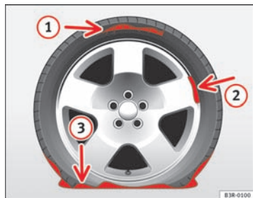
Fig. 200 Dommages pour lesquels le Tire-Mobility-System ne convient pas.
