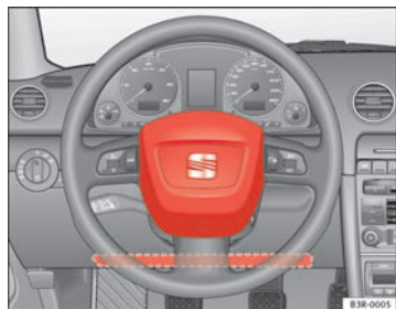
Fig. 17 Airbag du conducteur sur le volant et airbag genoux dans la planche de bord
