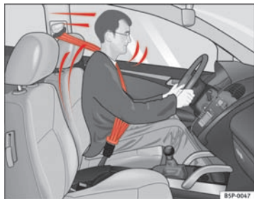
Fig. 10 Conducteur avec la ceinture de sécurité comme il convient : il est tenu par celle-ci en cas de freinage sec
