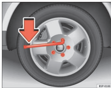
Fig. 195 Changement de roue : Desserrez les boulons de roue
