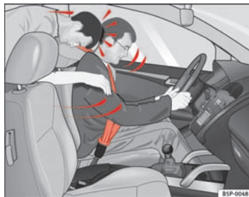
Fig. 9 Le passager arrière non attaché est projeté en avant et vient heurter le conducteur attaché
