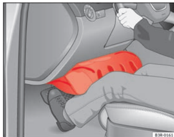
Fig. 22 Les airbag gonflés offre une protection en cas de collision frontale
