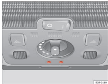
Fig. 95 Détail du ciel de pavillon : Éclairage d'ambiance
