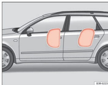
Fig. 24 Airbag latéral gonflé du côté gauche du véhicule
