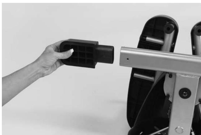
Insérez les deux larges pieds en caoutchouc dans chacune des extrémités des stabilisateurs arrière. Alignez les trous percés dans le pied et le tube. Vérifiez que les trous de vis sont alignés afin d'introduire une vis M4x18mm de chaque côté du pied .
