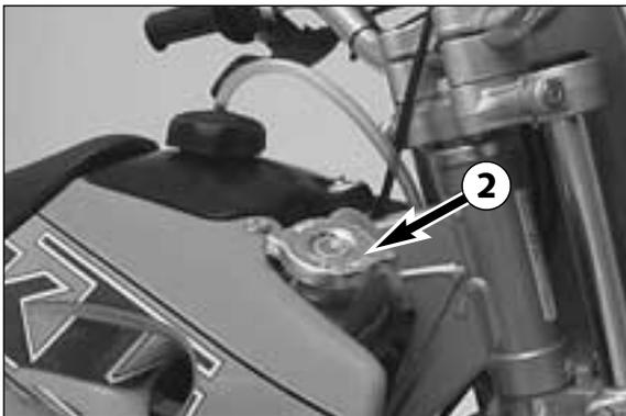
La surpression qui apparaît lorsque le liquide chauffe est réglée par un système de soupape dans le bouchon du radiateur ❷. On peut atteindre une température de 120° C sans gêner le fonctionnement.
