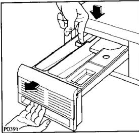
Les détergents et l'assouplissant s'incrustent à la longue. Nettoyer de temps en temps le tiroir bacs à produits sous un jet d'eau. A cette fin il est possible d'extraire complètement le tiroir de la machine en appuyant sur l'arrêt au fond à gauche.
