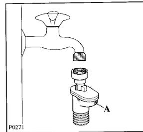
Le tuyau d'alimentation est équipé d'un dispositif de blocage de l'eau.
