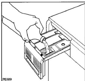
Verser, le cas échéant, l'assouplissant dans le bac ad hoc
