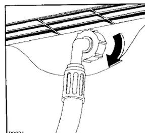
L'autre extrémité du tuyau d'arrivée, du côté de la machine, peut être orientée dans n'importe quelle direction. Dévisser un peu la bague de serrage, tourner le bout du tuyau et revisser solidement la bague.
