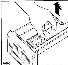
Pour faciliter le nettoyage la partie supérieure du bac réservé à l'assouplissant peut être enlevée.
