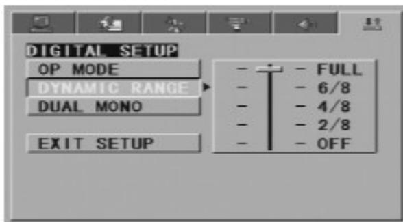
DYNAMIC RANGE: Lorsque "LINE OUT" est sélectionné, choisissez cette installation pour ajuster le ratio de sortie haut niveau et pour avoir un effet différent. Si vous ajustez jusqu'à FULL (complet), le pic de volume audio sera minimum; alors qu'en ajustant à OFF, il sera maximum..
