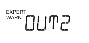
Fig. 65. OUT2 configurée comme sortie d'alarme
