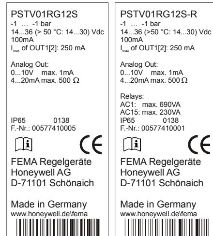
Fig. 19. Plaque d'identification du fabricant / Modèles PST... et PST...-R
