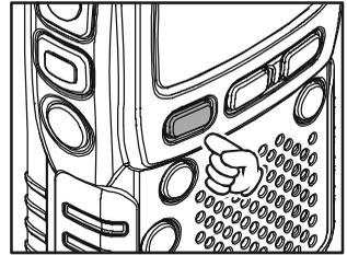
Si vous souhaitez inverser le sens de la recherche (par exemple passer en recherche en fréquence décroissante), tourner le **DIAL** juste d'un click dans le sens opposé (ici vers la gauche) pendant que le **VX-2E** est en mode recherche automatique. Pour inverser à nouveau le sens de la recherche tourner le **DIAL** d'un click dans l'autre sens.
