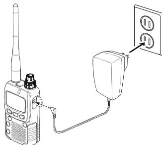
Quand la batterie est en cours de charge l'afficheur mentionne "CHGING" et l'indicateur **TX/BUSY** est rouge. Le s-mètre indique alors l'état de la charge. Quand le chargement de la batterie est terminé l'afficheur mentionne "CHGFUL" et l'indicateur **TX/BUSY** est vert.
