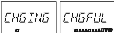
Si vous essayez de connecter le **NC-85** au **VX-2E** sans qu'il y ait une batterie à l'intérieur, l'afficheur mentionne "FL/NBT" pour vous inviter à installer la batterie. De même si vous essayez de connecter le **NC-85** au **VX-2E** alors que la batterie est chargée l'afficheur indique "CHGFUL".
