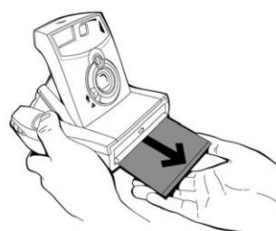
4 A tampa do filme é ejetada automaticamente.
