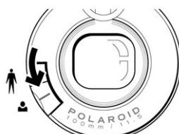
Pour les photos en gros plan, mettre l'interrupteur en position (**G**). Se tenir de 2 à 4 pi (0,6 à 1,2 m) du sujet. Le voyant rouge du mode gros plan s'allumera.
