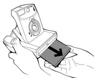
4 La cubierta de la película se expulsa automáticamente.
