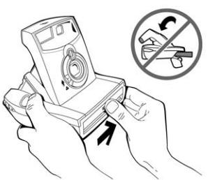
1 Ouvrir l'appareil photo. Glisser le loquet (h) afin d'ouvrir le compartiment.
