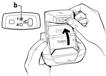
**1** Ouvrir l'appareil photo. Le témoin vert (**b**) s'allume sans clignoter lorsque la lampe-éclair est prête.
