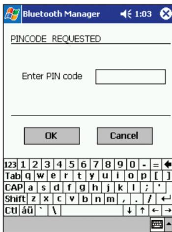
2. Sélectionnez « Create bond with this device » (Créer une liaison avec ce périphérique) dans le menu « Actions ». Un écran apparaît. Il vous invite à entrer un code PIN (voir Fig. 33, « Code PIN demandé »).
