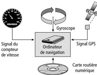
Le système de navigation est doté de capteurs qui perçoivent la position et les mouvements du véhicule. Le câble intégré au compteur de vitesse enregistre le chemin parcouru et le gyroscope (boussole inertielle) les braquages dans les virages. La position est déterminée via les satellites GPS (Global Positioning System).
