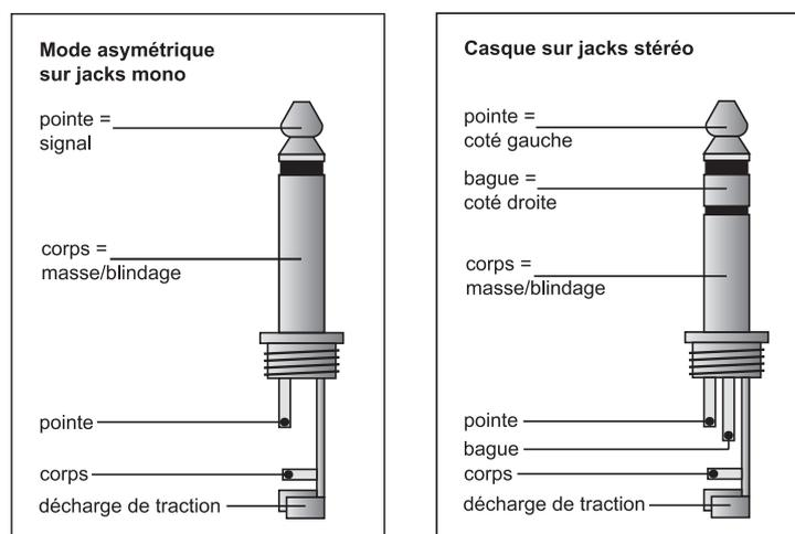
Fig. 3.1 : Câblage des jacks mono et du jack pour casque audio
