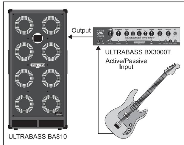
Fig. 3.3 : Système avec un BA810 et une tête BX3000T
