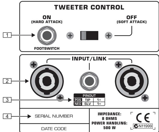
Fig. 2.1 : Commandes et connexions
