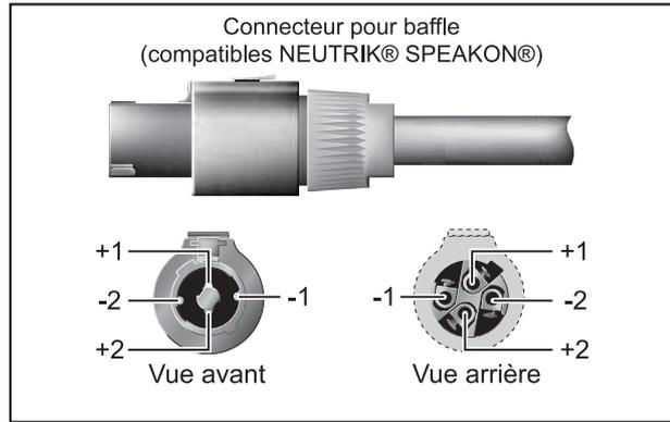
Fig. 4.2 : Connecteur pour baffle professionnel
