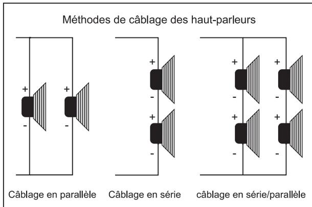
Fig. 4.1 : Les différentes méthodes de câblage
