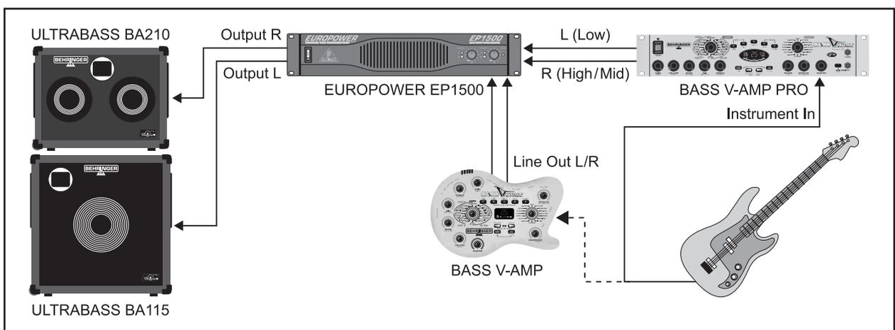
Fig. 3.4 : Bi-amplification : les aigus et les graves sont délivrés séparément par les baffles
