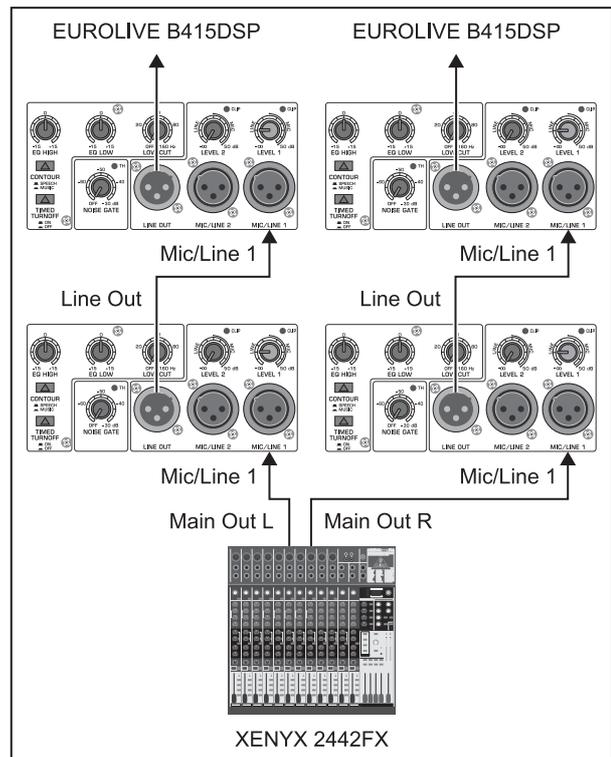
Fig. 3.3 : Chaînage de plusieurs B415DSP
