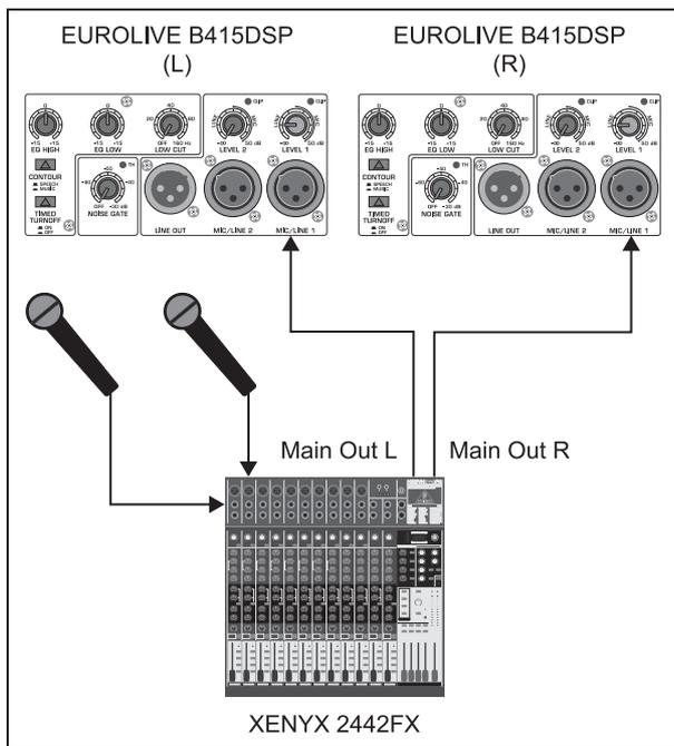
Fig. 3.2 : Câblage d'une table de mixage
