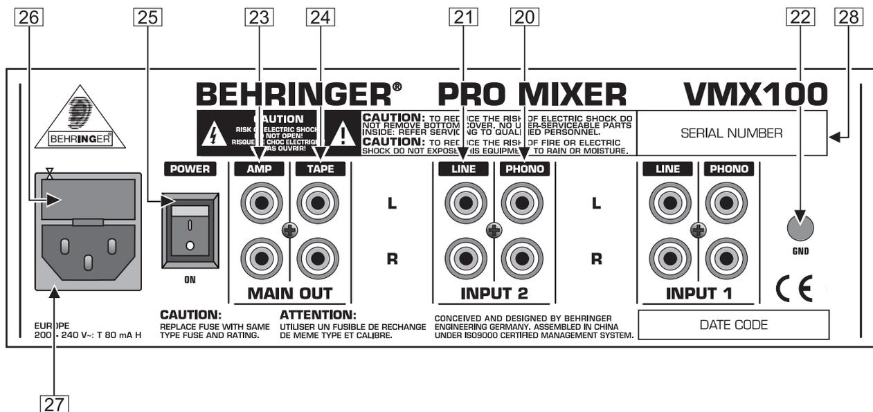
Fig. 3.1 : Le panneau arrière de la PRO MIXER VMX100
