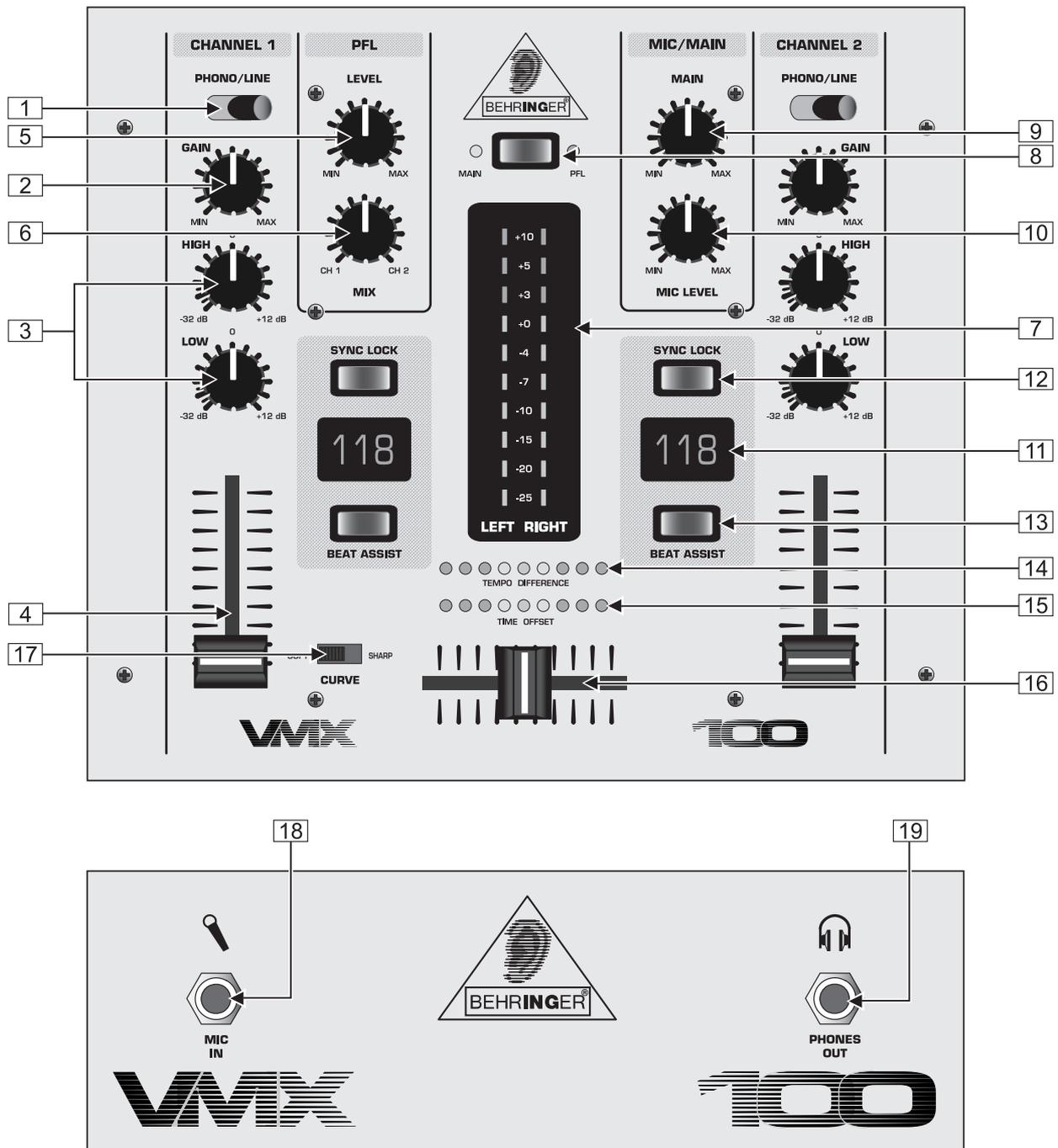
Fig. 2.1 : La face avant de la PRO MIXER VMX100
