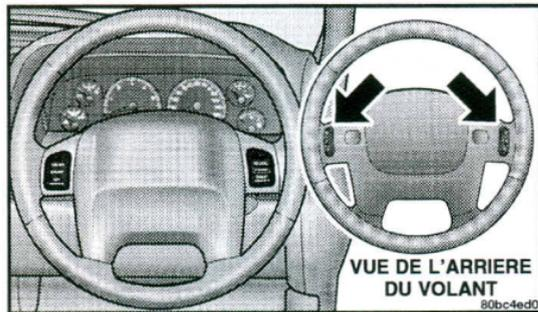
Le commutateur à bascule du côté droit possède également en son centre un bouton-poussoir et commande le volume et le mode du système audio. Enfoncez le haut du commutateur pour augmenter le volume et le bas, pour le diminuer. Appuyez sur le centre du commutateur pour commuter entre la radio AM et FM, le lecteur de cassettes ou de disques, selon l'appareil qui équipe le véhicule.
