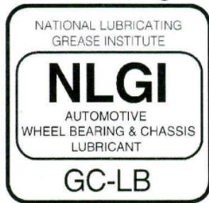
Le National Lubricating Grease Institute (NLGI) a créé un sigle d'homologation illustré ici qui facilite la sélection des graisses pour roulements et châssis. Le sigle est reproduit sur les bidons. Il précise l'usage et la qualité de la graisse.
