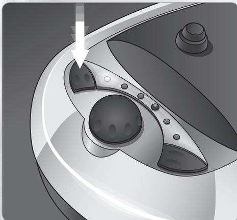
**6.** Enclenchez l'interrupteur de mise en service de la chaudière (8). Le voyant de contrôle (7) et le voyant d'auto-contrôle (4) s'allument. Ce dernier s'éteint au bout de quelques secondes.
