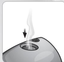
**3.** Lorsque le réservoir est plein, remettez le bouchon en le tournant d'1/4 de tour et repositionnez le réservoir amovible (21) à l'emplacement prévu en le poussant jusqu'à encliquetage du bouton de verrouillage (19).
