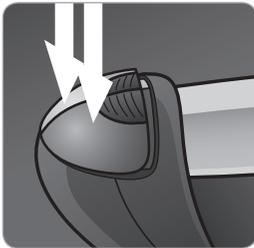
**11.** Ajustez si nécessaire le débit de vapeur en tournant le bouton de réglage (9). Seul le débit de vapeur sous le fer est ajustable. Le débit de vapeur frontale est toujours maximal.
