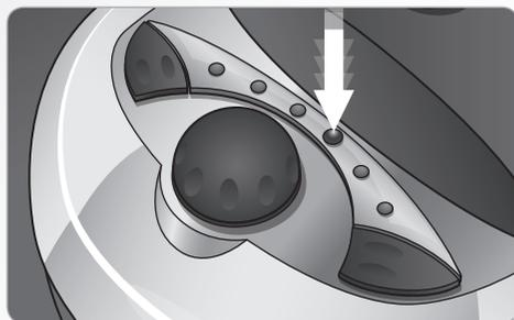
**5.** Enclenchez l'interrupteur de mise en service de la centrale (8).
