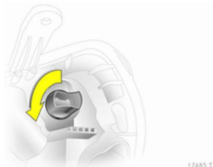
2. Faire tourner la douille de l'ampoule dans le sens antihoraire pour la désencliqueter.
