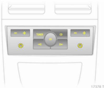
Twin Audio offre la possibilité d'écouter non seulement la source réglée sur l'Infotainment System mais aussi une autre source audio. Seule une source audio n'étant pas activée sur l'Infotainment System à ce moment-là peut être commandée.
