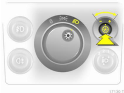
Luminosité réglable lorsque l'éclairage extérieur est allumé : Désencliqueter le bouton ☀ en appuyant dessus et le tourner à gauche ou à droite jusqu'à ce que la luminosité souhaitée soit obtenue.
