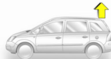
Le niveau arrière du véhicule est automatiquement ajusté aux conditions de charge tout en roulant. La suspension et la garde au sol sont augmentées, ce qui améliore la conduite.
