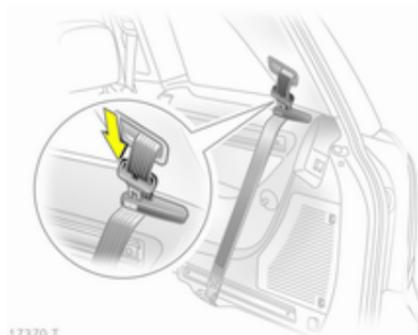
Guider la ceinture de sécurité dans le support de ceinture en cas de non-utilisation et insérer le verrou plat dans le support.
