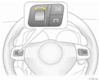
Une pression sur la molette appelle le menu **OB**. Dans le menu **OB**, ce bouton permet d'enclencher le chronomètre ou de le remettre à zéro.
