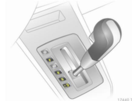
Le levier sélecteur peut uniquement quitter la position **P** ou **N** que si le contact est mis et si la pédale de frein est enfoncée (verrouillage du levier sélecteur).
