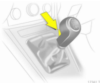
Marche arrière : lorsque le véhicule est à l'arrêt, soulever le bouton du levier sélecteur 3 secondes après avoir débrayé, engager la marche arrière.
