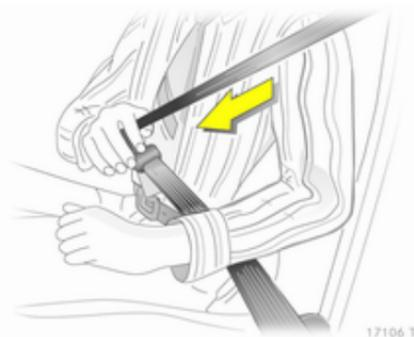
Tirer la ceinture hors de l'enrouleur, la guider sur le corps sans la vriller et encliquer le verrou plat dans la ceinture. En roulant, tendre régulièrement la sangle abdominale en tirant sur la sangle thoracique.
