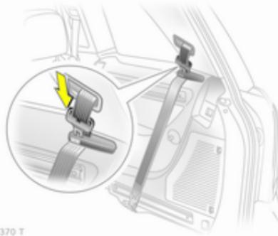
Faire passer les ceintures de sécurité dans le support de ceinture et insérer les verrous plats dans les supports.
