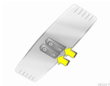
Actionnement avec commutateur (I = marche, 0 = arrêt, position centrale = éclairage automatique).
