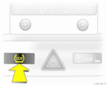
Après un changement de roue, le système doit être initialisé : gonfler les pneus à la pression prescrite, mettre le contact, appuyer sur le bouton **DDS** et le maintenir enfoncé pendant 4 secondes environ, le témoin  $\Delta$  clignote trois fois.
