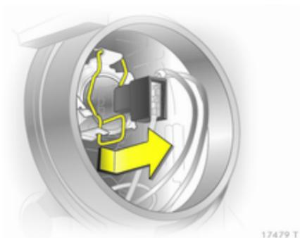
4. Dégager vers l'avant l'étrier en fil ressort en le sortant de l'attache et le basculer vers le bas.
