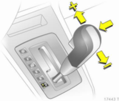
Déplacer le levier sélecteur de la position **D** vers la gauche puis vers l'avant ou l'arrière.
