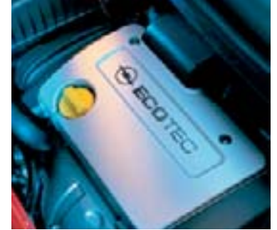
Optimisé pour le fonctionnement au gaz naturel, le moteur 1.6 ECOTEC® du Combo CNG développe 71 kW (97 ch).
