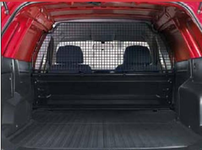
◀ **Espace de chargement.** L'Opel Astravan peut aisément accueillir une europalette chargée de côté. L'espace de chargement est pré-équipé d'un tapis de protection en caoutchouc. La cloison en acier à mi-hauteur peut-être complétée par une grille de séparation en option pour assurer la protection du conducteur et du passager.
