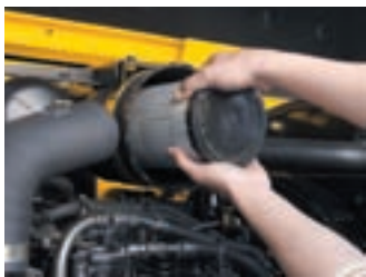
Filtre à air facile à remplacer La R55-7A est équipée d'un filtre à air en matière plastique durable facile à entretenir et rapide à remplacer.
