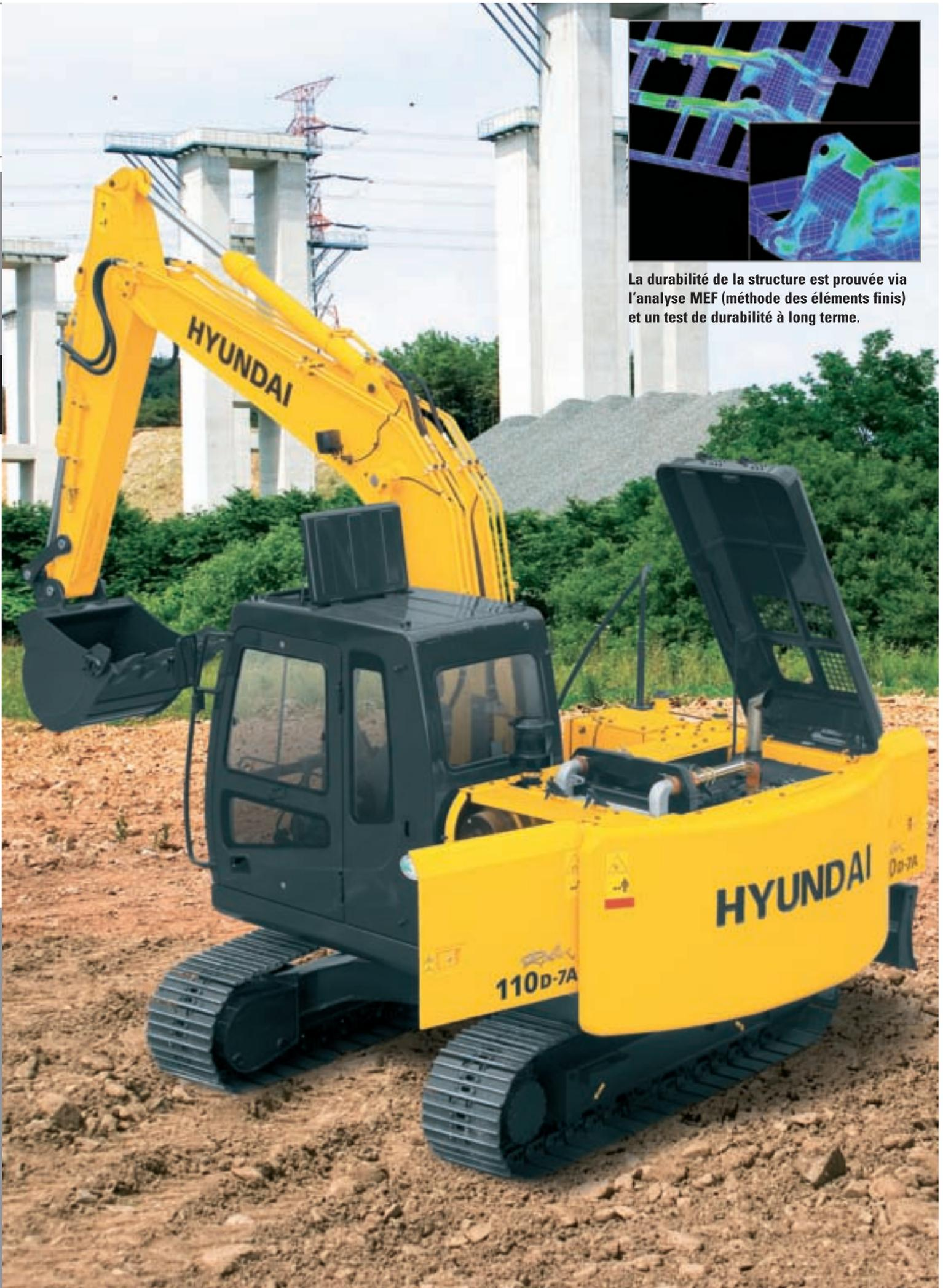
La durabilité de la structure est prouvée via l'analyse MEF (méthode des éléments finis) et un test de durabilité à long terme.
