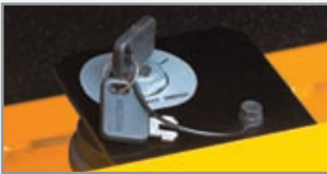
Interrupteur principal batterie
