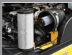
Changement du filtre à air (type cyclone de 6")
