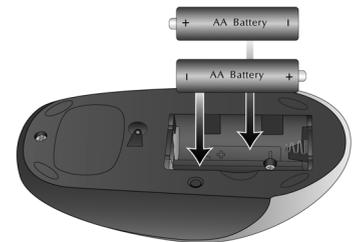
Figure 2-2: Insertion des piles
