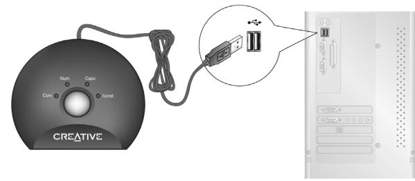
Figure 2-5: Connexion du récepteur RF à l'ordinateur
