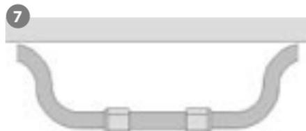
Installer le tube droit. Serrer les raccords à l'aide d'outils appropriés (pour un assemblage par évasement, utiliser une clé pour l'écrou et une seconde pour le raccord-union cylindrique). Le raccord doit être assez serré pour éviter toute fuite. Remplacer les brides de maintien du tuyau.
