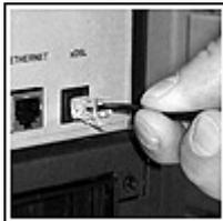
2. Connectez l'autre prise RJ11 du cordon téléphonique à la Freebox, dans la prise marquée "xDSL" en face arrière
