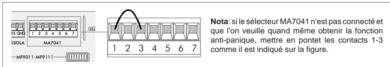
**Nota:** si le sélecteur MA7041 n'est pas connecté et que l'on veut quand même obtenir la fonction anti-panique, mettre en pontet les contacts 1-3 comme il est indiqué sur la figure.
