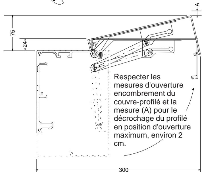
Respecter les mesures d'ouverture encombrent du couvre-profilé et la mesure (A) pour le décrochage du profilé en position d'ouverture maximum, environ 2 cm.
