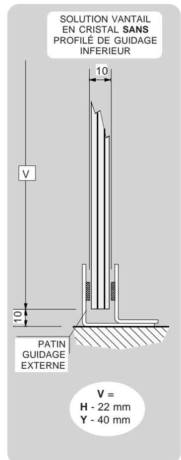
SOLUTION VANTAIL EN CRISTAL SANS PROFILÉ DE GUIDAGE INFÉRIEUR
