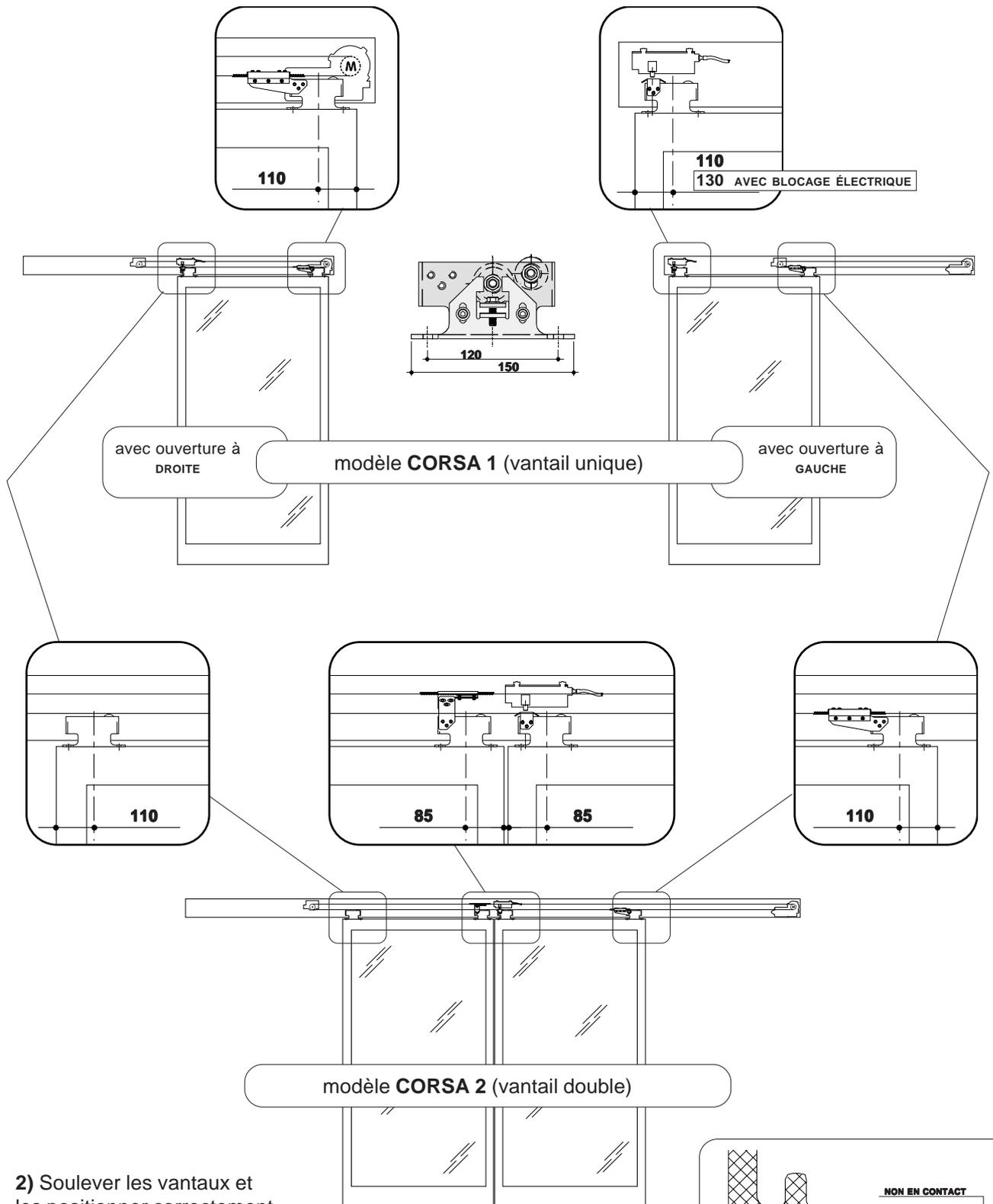
2) Soulever les vantaux et les positionner correctement sur le rail de coulissement ;
