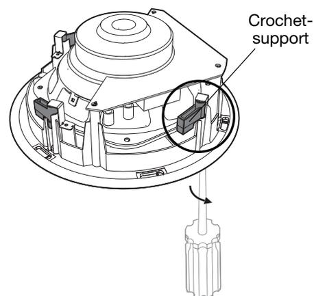
**ATTENTION :** Serrez ces vis fermement mais sans excès, afin d'éviter de comprimer le matériau du plafond, faute de quoi l'écrasement ou l'effritement de ce matériau créerait une inégalité de surface entre la face d'appui de l'enceinte et le pourtour du trou.
