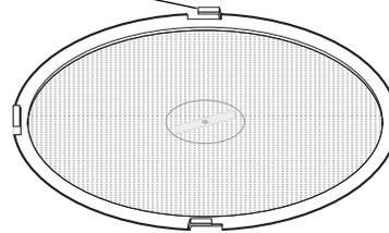
3. Sur le pourtour de l'enceinte, notez les six encoches dans lesquelles doivent s'enclencher les loquets.
