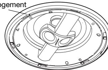
4. Pressez la grille sur le pourtour de l'enceinte pour engager les loquets, puis faites légèrement tourner la grille pour les bloquer.
