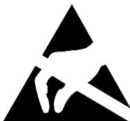
Les cartes constituées de composants à risque électrostatique (ESD = Electrostatic Sensitive Devices) sont signalées par l'étiquette ci-contre :
