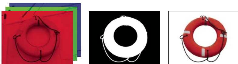
Couches de couleur séparées (gauche), couche alpha (milieu) et toutes les couches de couleur ensemble (droite)
