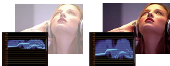
Correction de l'exposition : image surexposée avec la forme d'onde dans les limites supérieures de l'échelle IRE (gauche) et l'image corrigée avec la forme d'onde comprise entre 7,5 et 100 IRE (droite)
