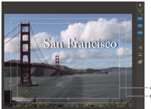
Marges admissibles pour le titre et l'action A. Marge admissible pour le titre B. Marge admissible pour l'action
