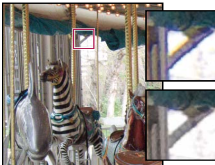
Photo d'origine avec frange bleue/jaune (à gauche) et photo après la correction de l'aberration chromatique (en bas à droite)
