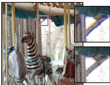
Image d'origine (en haut) et après correction de l'aberration chromatique (en bas)
