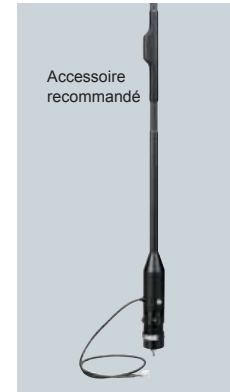
AT-230 ANTENNE AVEC ACCORDEUR D'ANTENNE INCORPORE (Moonraker) Antenne de 2,6m avec accordeur d'antenne incorporé couverture 2–30MHz. Une porteuse continue à forte puissance n'est pas garantie avec l'AT-230.
