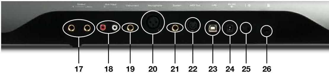
17. **Entrées principales 1/4" (Output R-L/Mono) :** Reliez ces sorties principales TS asymétriques à votre mélangeur, enceintes actives ou amplificateur. Ces jacks offrent un signal mélangé composé des sons de piano interne du ProKeys Sono, du signal de toutes les entrées du clavier (mic, instrument et auxiliary) et du signal audio entrant depuis votre ordinateur. Si vous êtes connecté à un dispositif ou un amplificateur mono (simple canal), utilisez la sortie 1/4 gauche.
