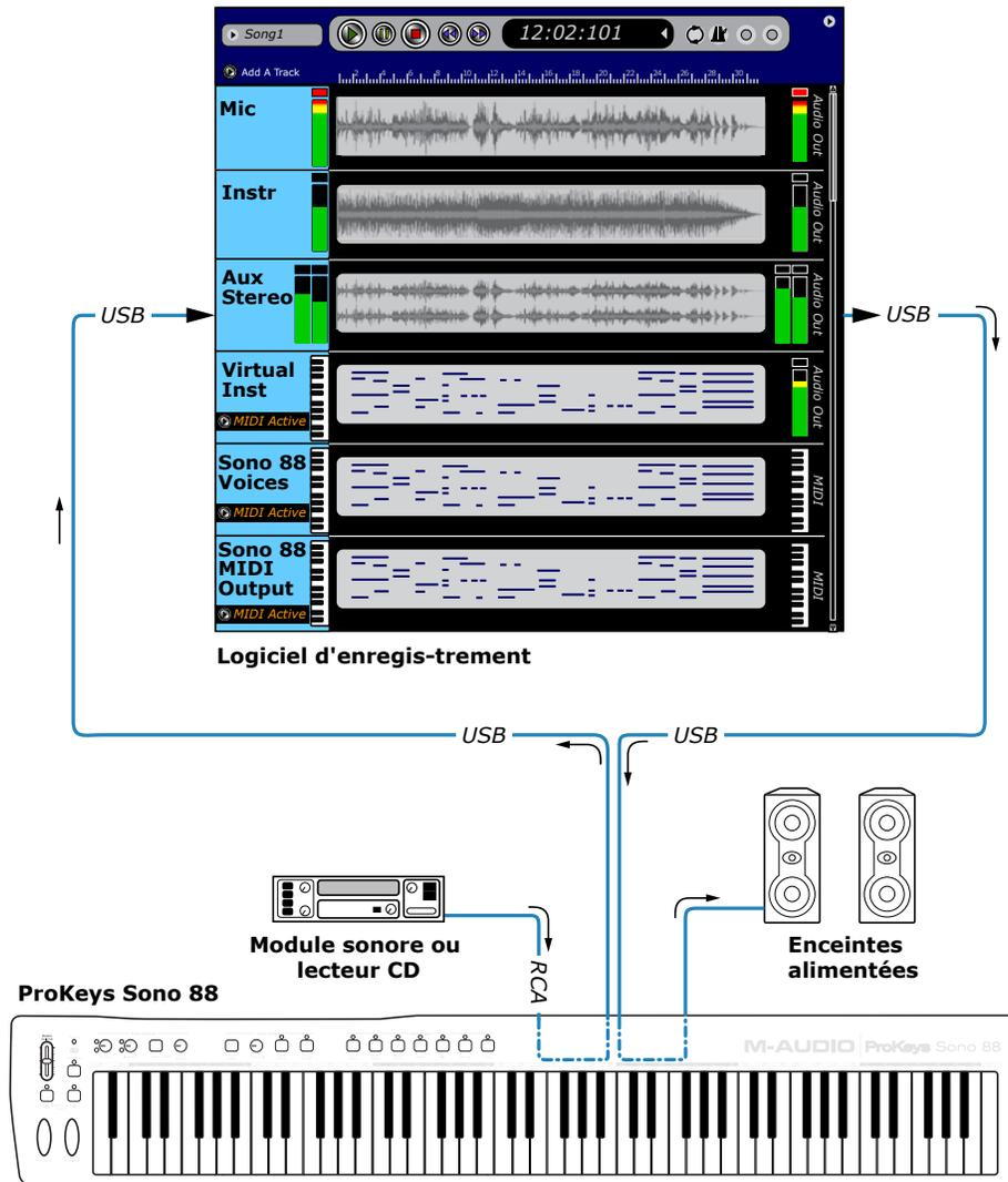
Une fois encore, le ProKeys Sono est utilisé comme interface audio. Toutefois, dans ce scénario, les prises d'entrée auxiliaires sont utilisées pour enregistrer la sortie d'un dispositif externe (tel qu'un module sonore, un lecteur CD ou tout autre dispositif de niveau de ligne).
