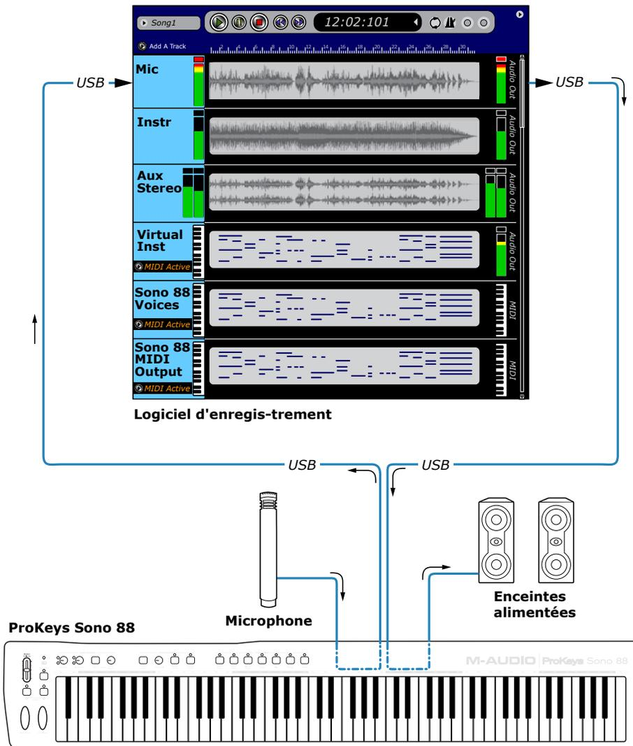
Dans ce scénario, le ProKeys Sono est utilisé en tant qu'interface audio pour enregistrer un microphone.
