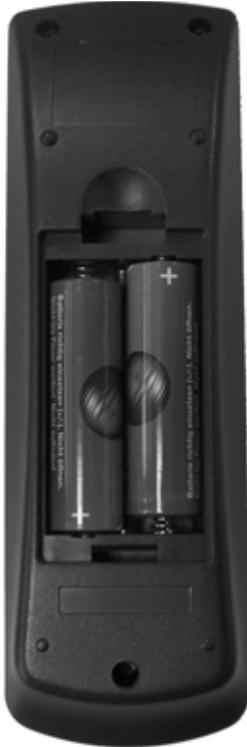
La télécommande a besoin de 2 piles de type R03 1,5 V.
