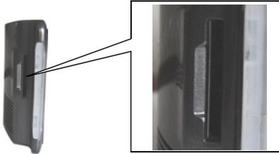
Sur le côté gauche de l'appareil se trouve le logement de la carte. Le logement de la carte est équipé d'un mécanisme d'encliquetage et d'éjection à ressort.
